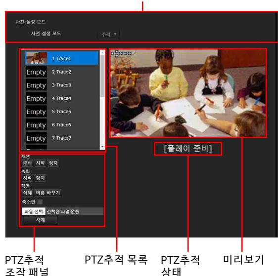
PTZ TRACE는 리모트 커맨더 또는 리모트 컨트롤러로 작동되는 팬/틸트/줌 조작을 기록한 다음, 필요시 조작을 재생하는 데 사용되는 기능입니다. 최대 16개의 팬/틸트/줌 위치를 최대 180초간 기록할 수 있습니다.
